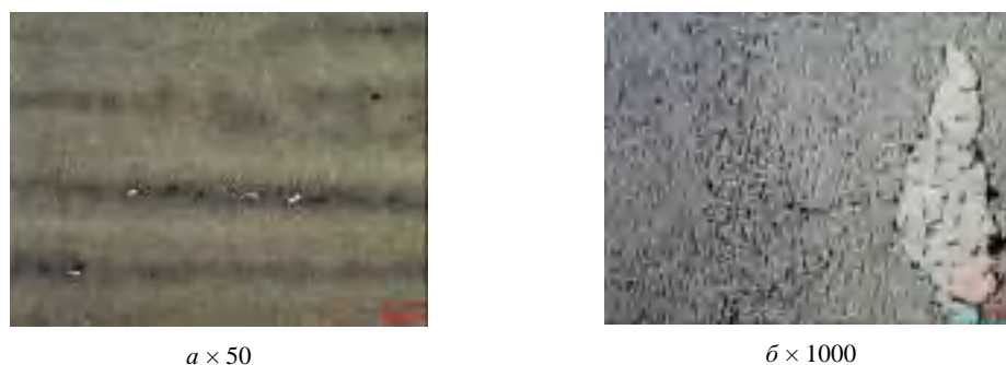
Рис. 7. Редко встречающиеся частицы эвтектической фазы типа ( \gamma - \gamma' ) в термообработанном образце из сплава CMSX-4 PLUS производства фирмы «CANNON-MUSKEGON CORPORATION»
