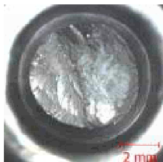
Рис. 3. Стрoение излома монокристаллического термообработанного образца, отлитого из сплава CMSX-4 PLUS производства фирмы «CANNON-MUSKEGON CORPORATION» после испытаний на растяжение при комнатной температуре, \times 10
