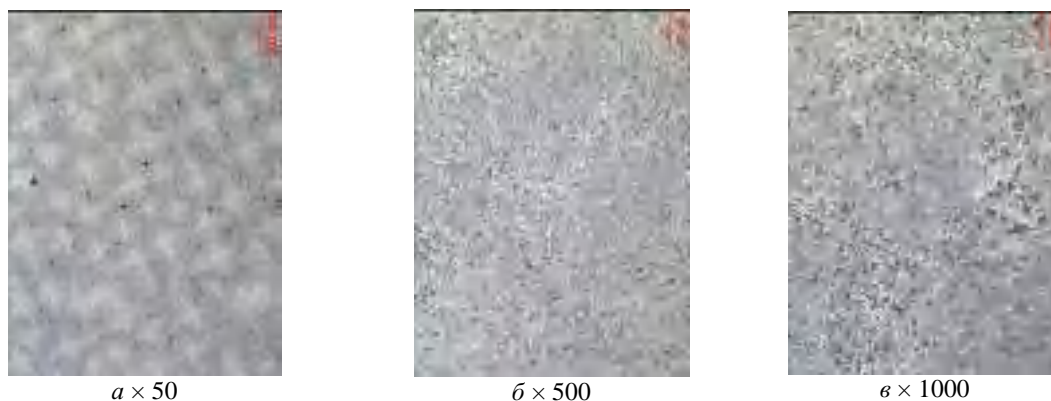
Рис. 6. Микроструктура образца \varnothing 15 мм, отлитого из сплава CMSX-4 PLUS производства фирмы «CANNON-MUSKEGON CORPORATION» после термообработки
