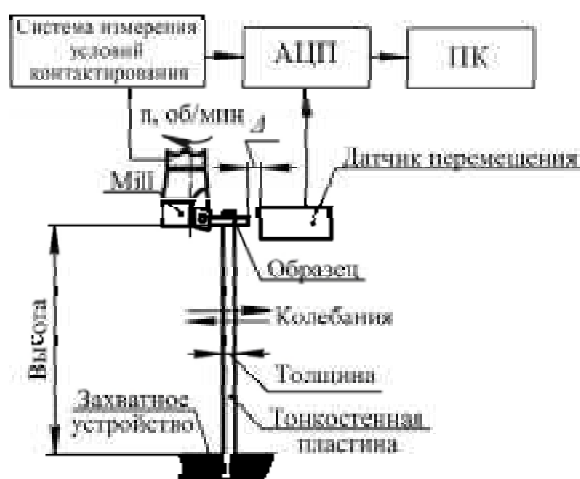
Рис. 4. Экспериментальный стенд для изучения высокоскоростного фрезерования тонкостенных деталей
