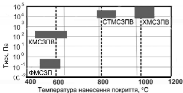
Рис. 1. Параметри основних методів отримання покриттів з газової фазової фази у вакуумі (або в атмосфері робочого газу)
