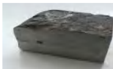
б – зразки наплавки понад 40 % металевого наповнювача в термітній шихті
