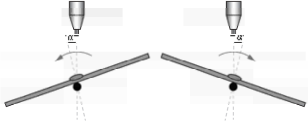
Рис. 2. Принципиальная схема перемещения станины (поз. 3) в процессе колебаний
