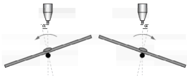
Рис. 1. Принципиальный вид подвижной станины
