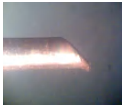
Рис. 1. Внешний вид оплавившегося торца проволоки марки М1
