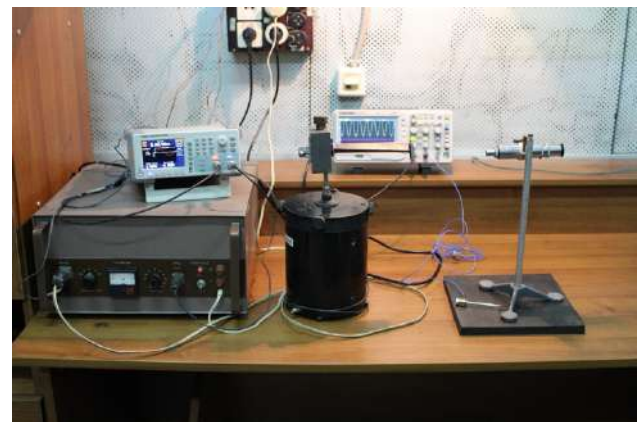
Рисунок 2. Схема для дослідження кутів переміщення бандажної полиці
