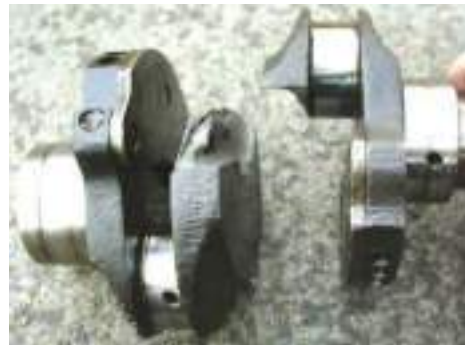
Рисунок 1. Неповноопорний колінчастий вал зі зломом по центральній щоці
