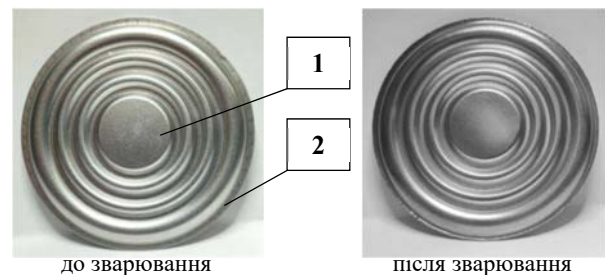
Рисунок 1. Зовнішній вигляд коробки мембранної: 1 – опора ( \delta = 0,3 мм); 2 – мембрана ( \delta = 0,15 мм);
