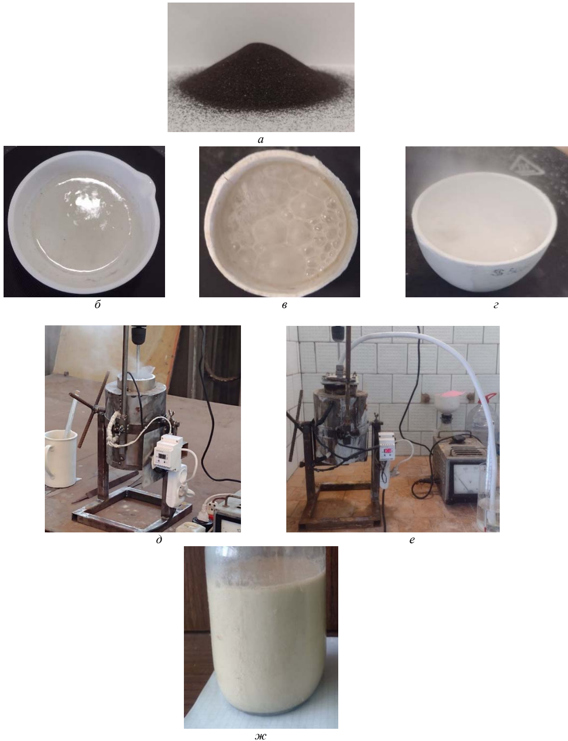
Рисунок 1. Візуалізація процесу розкриття ільменіту – вихідні матеріали, реактор та продукт: концентрат ільменіту (а); фториду амонію (початок нагрівання) (б); фториду амонію (кипіння) (в); фториду амонію (розкладання) (г); ведення реакції у відкритому реакторі (д); ведення реакції у закритому реакторі (е); суспензія (продукт реакції в накопичувальній ємності) (ж)
