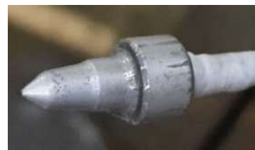
Рисунок 6. Короткий зразок після МДО впродовж 15 с
