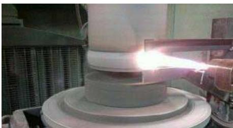
Рисунок 1. Нанесення порошкового покриття на плазмотроні «Метко 9МВМ»
