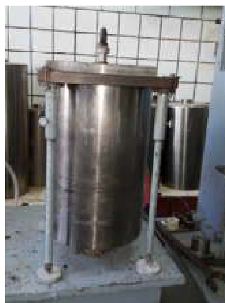
Рис. 3. Общий вид установки для ультразвукового упрочнения
