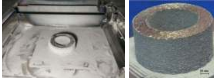
Рис. 2. Внешний вид изделия, полученного методом 3D печати из титановых порошковых материалов с несферической формой частиц
