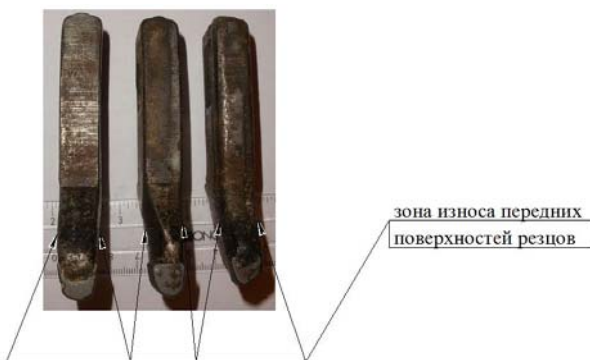
Рис. 5. Характер износа передней грани резцов
