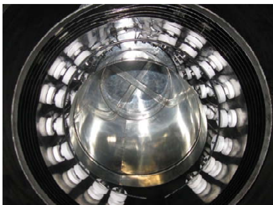
Рис. 5. Молибденовый нагревательный модуль с муфелем колпака печи модели СГВ-2.4-2/15-ИП-ОТТОМ
