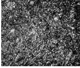
Рис. 3. Микроструктура стали 30XГСА после изотермической заковки из МКИТ, \times 500 \times 1,4
