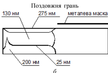
Рис. 4. Загальний вигляд пластини зі скла К8 прямокутної форми з картиною подвійного променезаломлення (а) та відповідна їй схема з зображенням зон і величин напружень (б). Прилад ПКС-250
