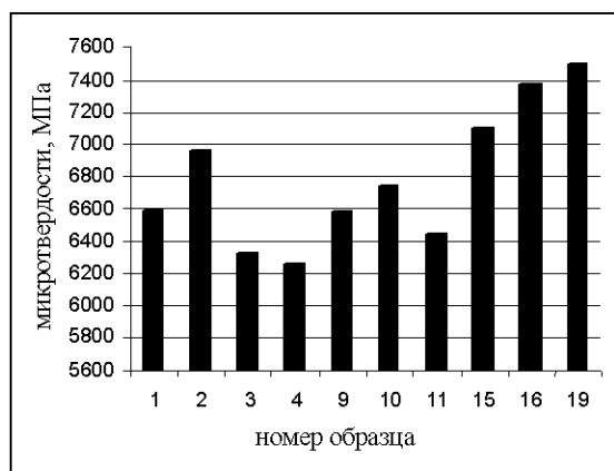
Рис. 6. Микротвердость кристаллов \beta -Si твердого раствора (а) и эвтектики \alpha -Al- \beta -Si (б) в образцах заэвтектического силумина после водородной обработки
