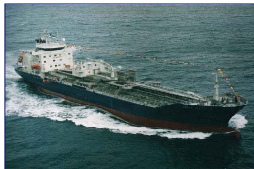
Рис. 3. Танкер для перевозки продукции химической промышленности, построенный с широким применением двухфазной стали
