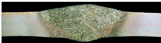
Рис. 2. Сварной шов изделия из двухфазной стали
