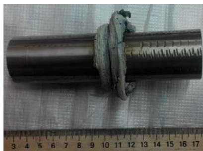
Рис. 1. Сваренные заготовки, полученные на основе метода порошковой металлургии
