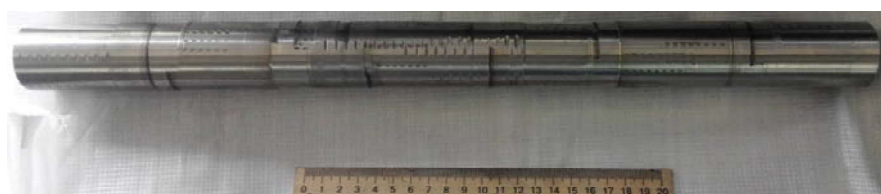
Рис. 4. Прутки \varnothing 40 мм, полученные на основе метода порошковой металлургии и сварки
