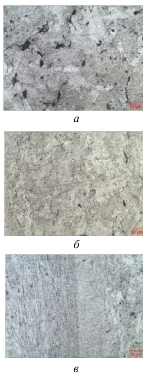
Рис. 2. Микроструктура сваренных заготовок из спеченного титана типа ВТ1-0: а – основной металл; б – ЗТМВ; в – сварной шов
