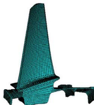
Рис. 3. Конечно-элементная модель сектора моноколеса из сплава BT8
