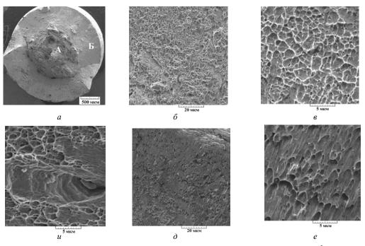
**Рис. 8.** Фрактография усталостного разрушения образца серии 3 ( $\sigma = 900$ МПа,  $N = 3 \cdot 10^3$  циклов)
