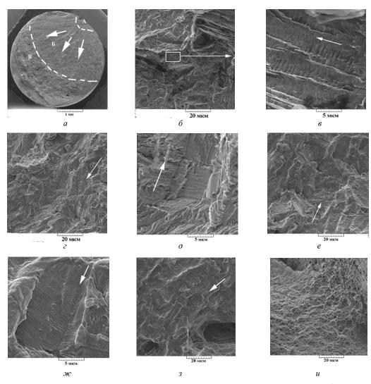
**Рис. 7.** Фрактография усталостного разрушения образца серии  $2(\sigma = 550 \text{ M}\Pi a, N = 4,5 \cdot 10^6 \text{ циклов})$
