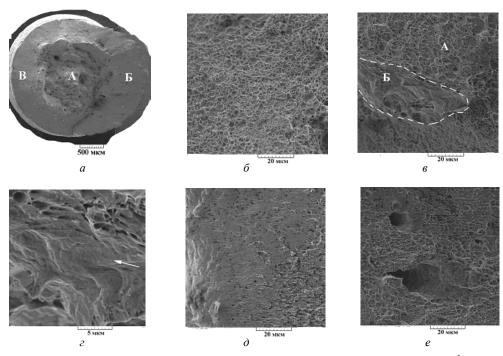
**Рис. 6.** Фрактография усталостного разрушения образца серии 2 ( $\sigma = 900 \text{ M}\Pi \text{a}$ ,  $N = 2,1 \cdot 10^3 \text{ циклов}$ )
