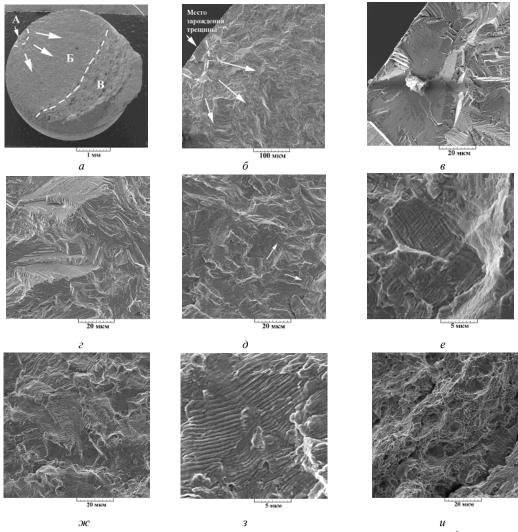
**Рис. 9.** Фрактография усталостного разрушения образца серии 3 ( $\sigma$  = 550МПа, N = 6,2·10<sup>6</sup> циклов)
