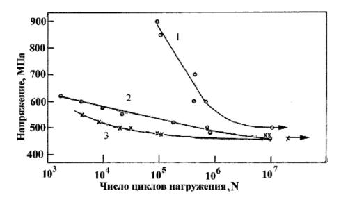
Рис. 3. Кривые усталости гладких образцов из стали 05Х22АГ15Н8М2Ф-Ш:
