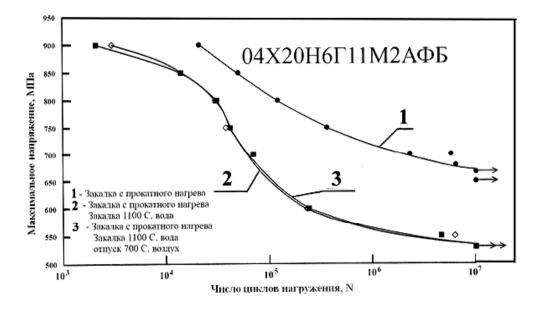
**Рис. 2.** Кривые усталости стали 04X20H6Г11М2АФБ (номера кривых усталости соответствуют сериям образцов по таблице 2)
