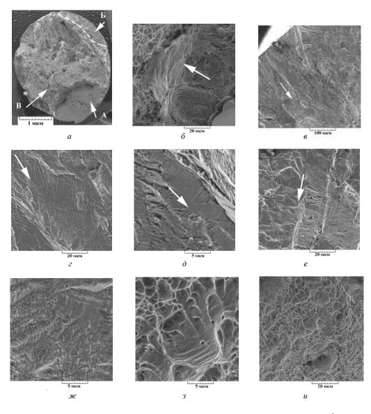
**Рис. 4.** Фрактография усталостного разрушения образца серии 1 ( $\sigma = 900 \text{ M}\Pi \text{a}, N = 2,1 \cdot 10^4 \text{ циклов}$ )
