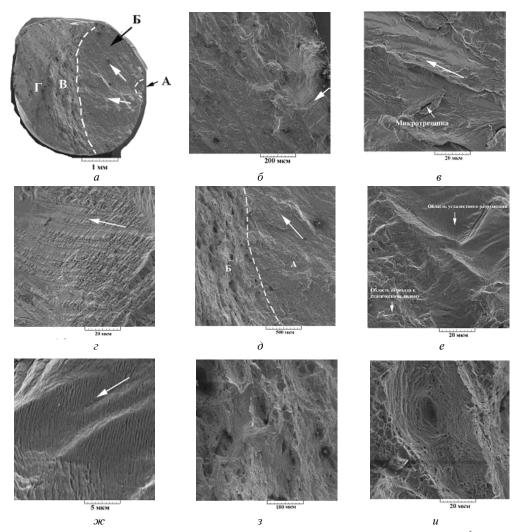
**Рис. 5.** Фрактография усталостного разрушения образца серии  $1(\sigma = 700 \text{М}\Pi \text{а}, N = 5,7 \cdot 10^6 \text{ циклов})$
