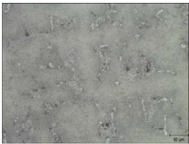
Рис. 3. Мікроструктура робочої лопатки із сплаву ЖС26-ВИ після процедури обробки ГП: a – \times 200 ; б – \times 500
