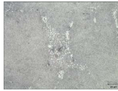
Рис. 3. Мікроструктура робочої лопатки із сплаву ЖС26-ВИ після процедури обробки ГП: a – \times 200 ; б – \times 500
