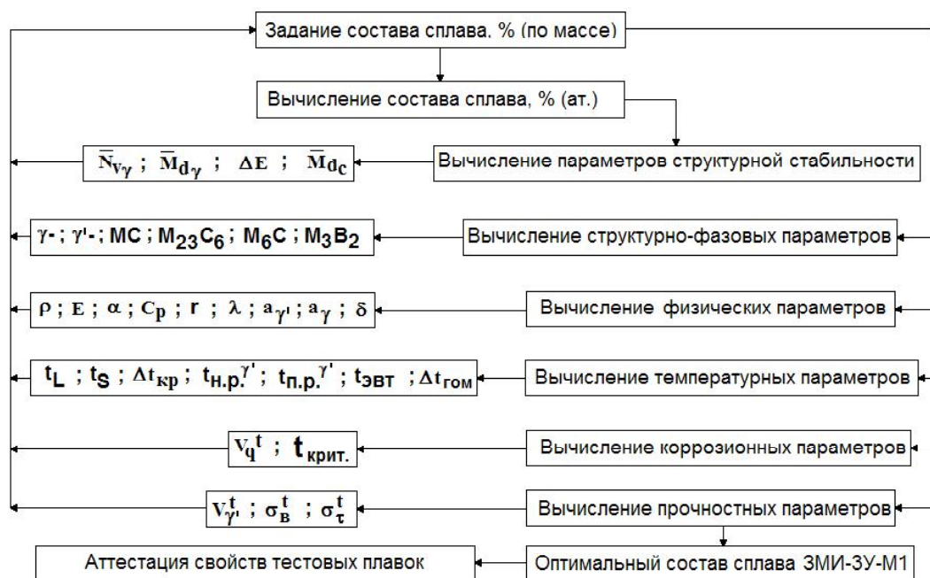
Рис. 1. Алгоритм компьютерного расчета проектируемого сплава ЗМИ-3У-M1 по разработанной методике КРАМ [12]
