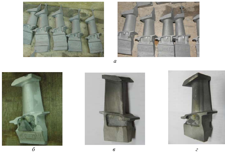
Рис. 2. Литые рабочие лопатки турбины высокого давления (ТВД) с направленной (моно) структурой турбины Д-336, изготовленных из спроектированного сплава ЗМИ-3У-М1 в промышленных условиях ГП «Ивченко-Прогресс»: a – внешний вид отлитых лопаток со стартовыми кристаллами и конусами; б, в – брак лопаток по макроструктуре; г – макроструктура годной лопатки
