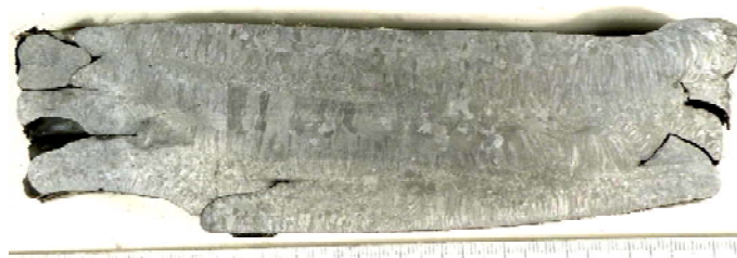
Рис. 2. Макроструктура темплета, вырезанного в осевом сечении слитка, полученного из возврата сплава ЖС26-ВИ после рафинирования методом ЭЛП
