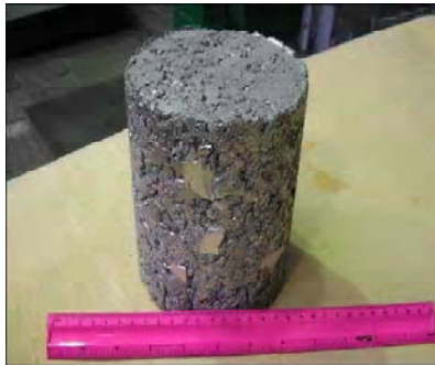
Рис. 2. Прессованный брикет из титановой губки и алюминия
