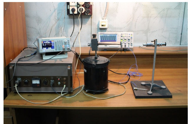
Рисунок 2. Схема для дослідження кутів переміщення бандажної полиці
