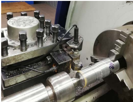
Рисунок 1. Робоче місце для дослідження вібрацій
