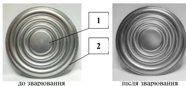
Рисунок 1. Зовнішній вигляд коробки мембранної: 1 – опора ( \delta = 0,3 мм); 2 – мембрана ( \delta = 0,15 мм);
