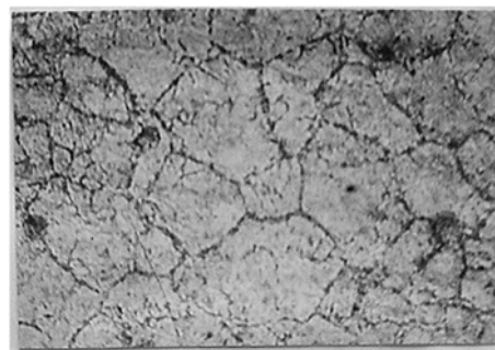
Рисунок 5. Феритне зерно в сплаві МЖ ( a ), аустенітне зерно в сталі 30XГСНА ( б ), \times 500 [3]
