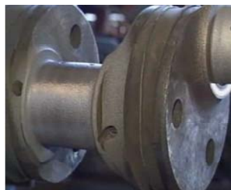
Рис. 1. Плазменное покрытие на поверхности шейки коленчатого вала трактора
