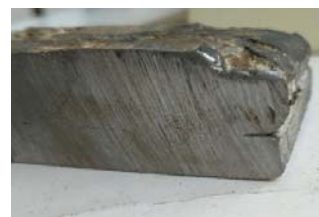
а – зразки наплавки при 40 % металевого наповнювача в термітній шихті
