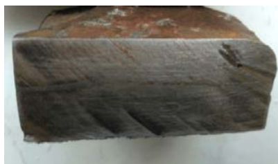
а – зразки наплавки при 40 % металевого наповнювача в термітній шихті
