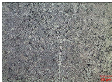
Рис. 8. Малоугловые границы зерен в монокристаллических образцах, отлитых из сплава CMSX-4 PLUS производства фирмы «CANNON-MUSKEGON CORPORATION» после термообработки
