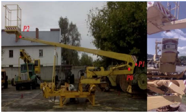
Рис. 5. Розташування датчиків на експериментальному АГП
